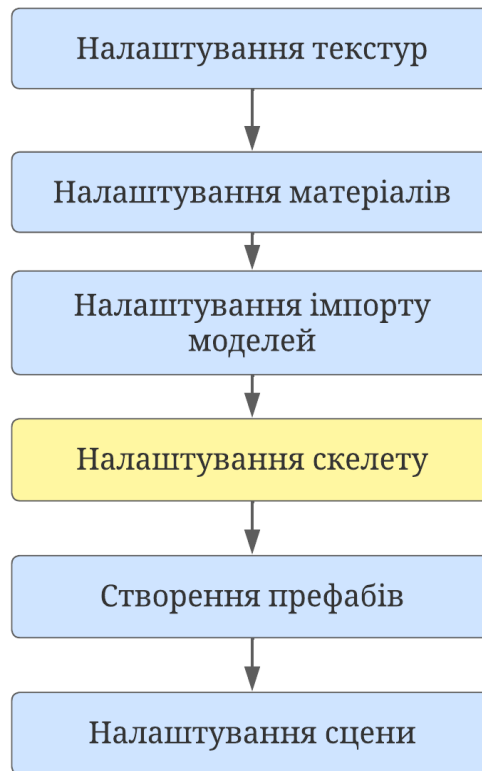
Рисунок 3.2 – Узагальнений виробничий процес налаштування контенту в Unity
