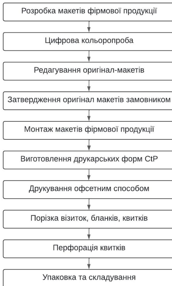
Рисунок 8.1 – Технологічна схема офсетного друку
