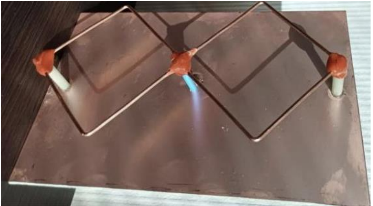
Рисунок 4.13 – Зовнішній вигляд виготовленої антени біквадрат.
