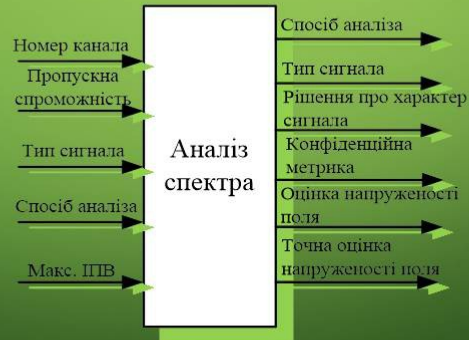
Рисунок 5 - Узагальнена структурна схема моніторингу спектра
