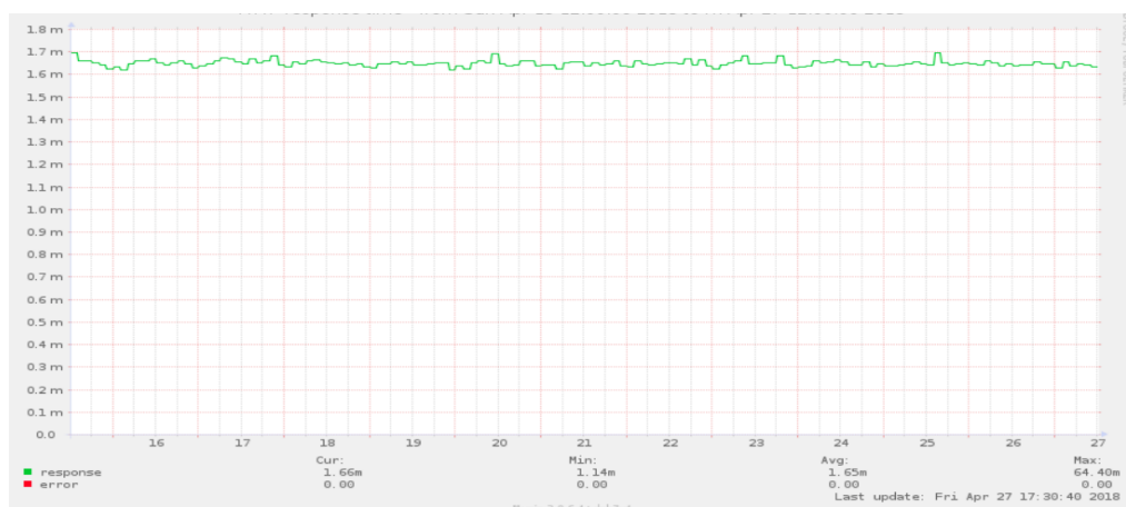
Рис. 10. Час відповіді сервера походження без використання методу оптимізованого кешування
