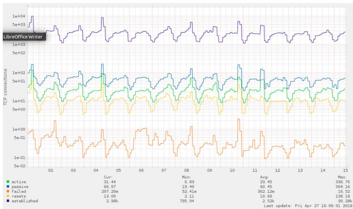
Рис. 12. Кількість TCP-з'єднань до сервера походження з використанням методу оптимізованого кешування
