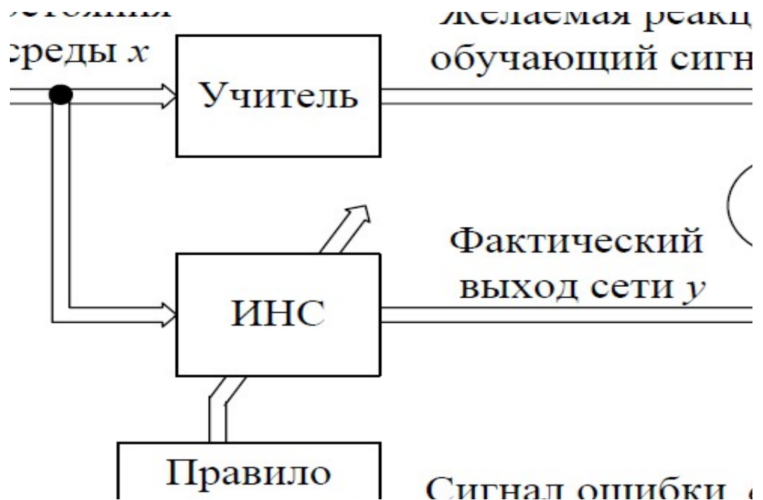
Рисунок 2.7 – Схема навчання нейронної мережі з учителем
