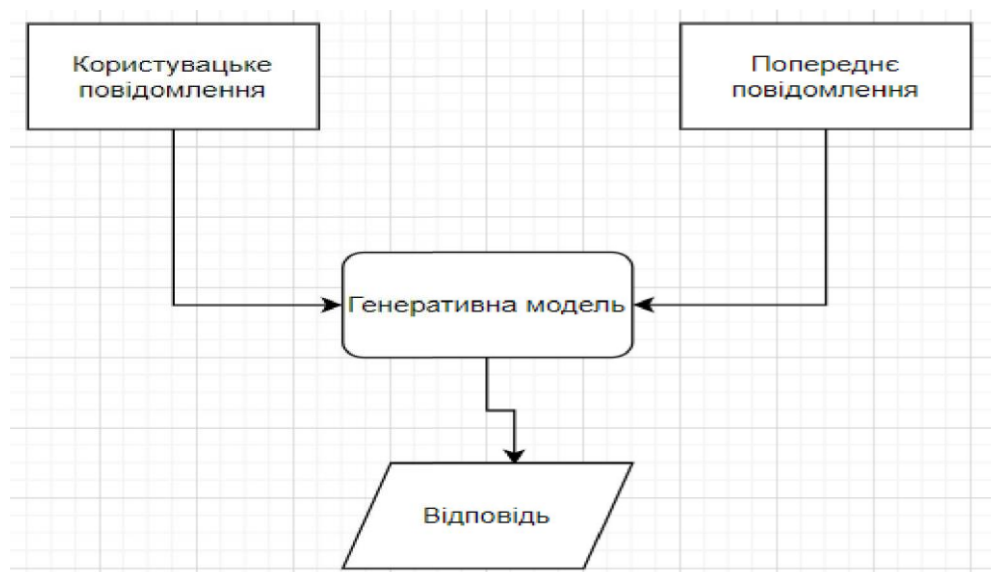
Рисунок 2.6 – Блок-схема роботи генеративної моделі
