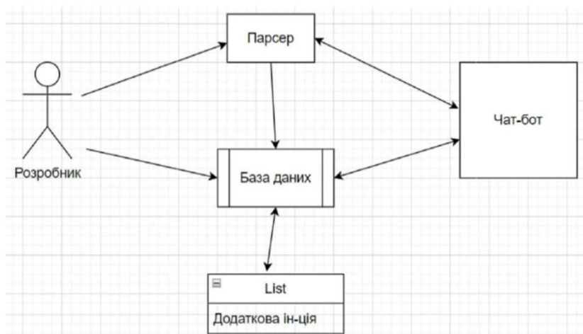
Рисунок 3.5 – Декомпонована схема ІС
