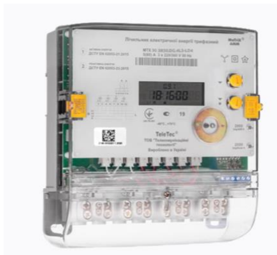
Рисунок 2.10 – Електролічильник з вбудованим радіомодулем LoRaWAN
