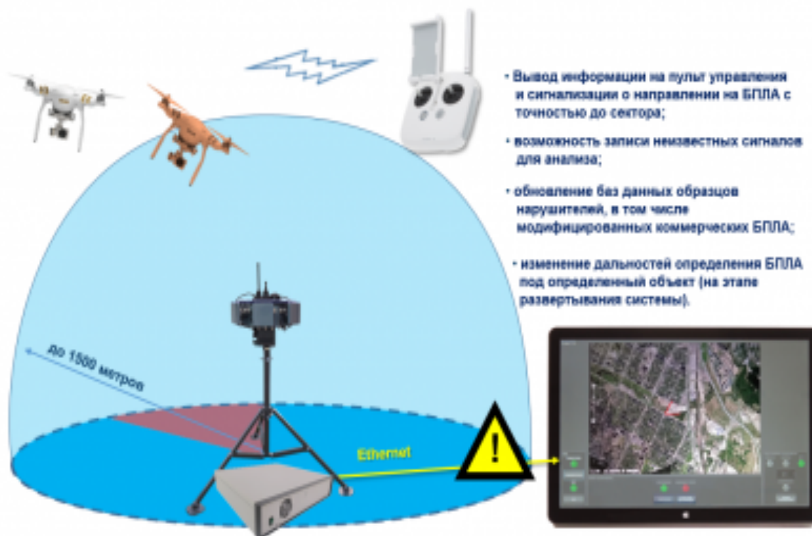
Рис.1.4 – схема роботи комплексу для виявлення БПЛА "СОЛОВЕЙ-2"
