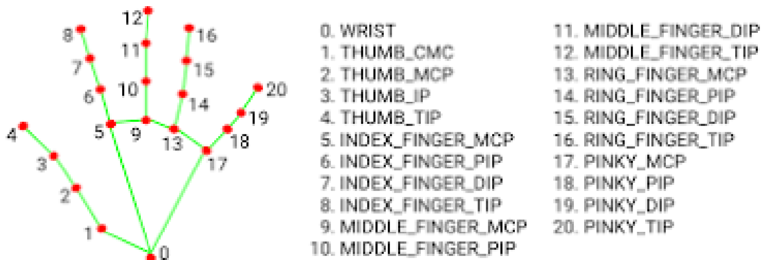
Рисунок 1 – Біомеханічна оцінка рухових порушень рук за ключовими точками віртуального скелета кисті на базі технології комп'ютерного зору
