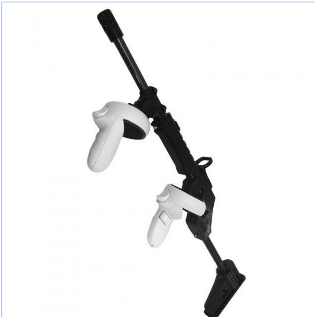
Рисунок 3.3 – макет-насадка на контролер Oculus Touch з магнітним кріпленням
