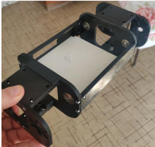
Рисунок 2.14 – Базовий каркас мобільного робота зі встановленими фланцевими кульковими підшипниками типа F625zz
