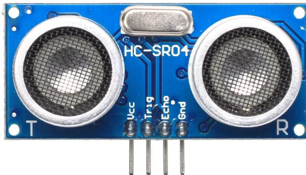
Рисунок 2.3 – Ультразвуковий датчик відстані HC-SR04 [10]
