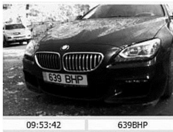
Рисунок 1.4 – Приклад роботи функції ANPR
