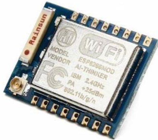
Рисунок 2.5 – Мікроконтролерний модуль ESP8266 [11]
