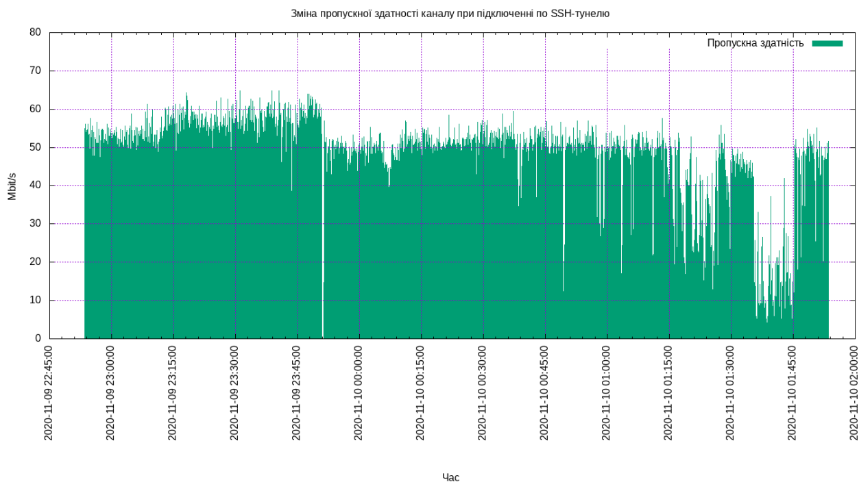
Рисунок 3.6 — Зміна пропускної здатності при підключенні по SSH-тунелю через нестандартний порт
