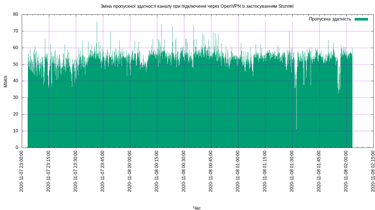
Рисунок 3.25 – Зміна пропускної здатності каналу мережі OpenVPN із застосування програми Stunnel
