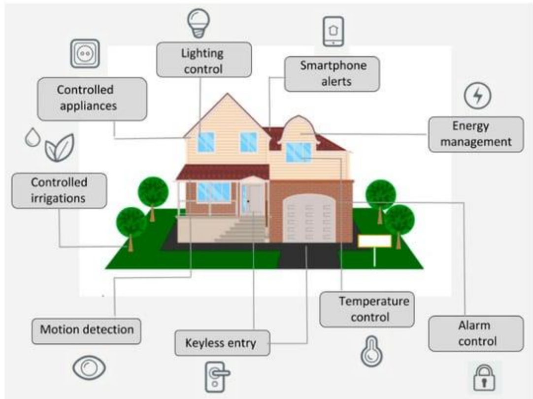
Рисунок 1.1 – схема розумного будинку з використанням IoT-технологій
