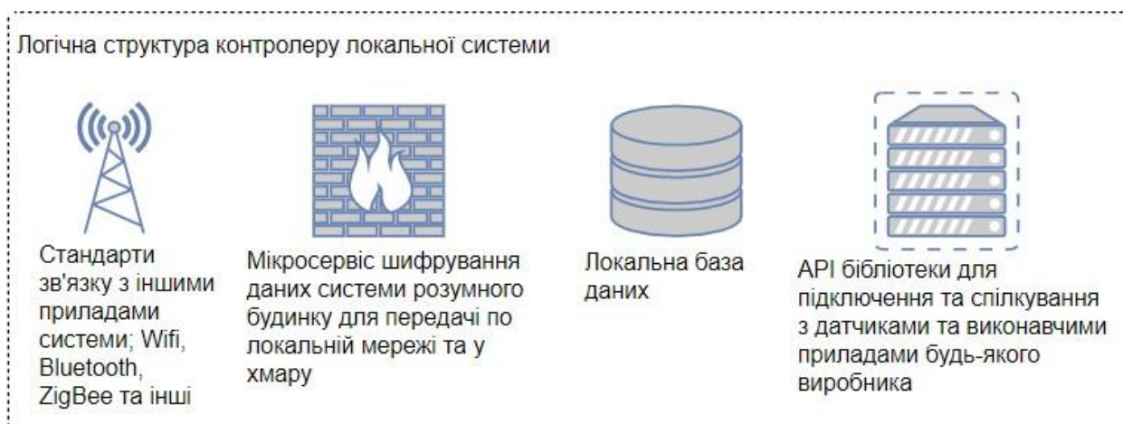
Рисунок 1.3. – Логічна структура локального контролеру системи підземного приміщення
