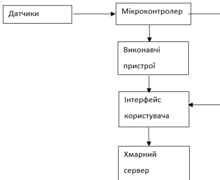
Рисунок 3.7 – Структурна схема системи контролю мікроклімату в підземному приміщенні
