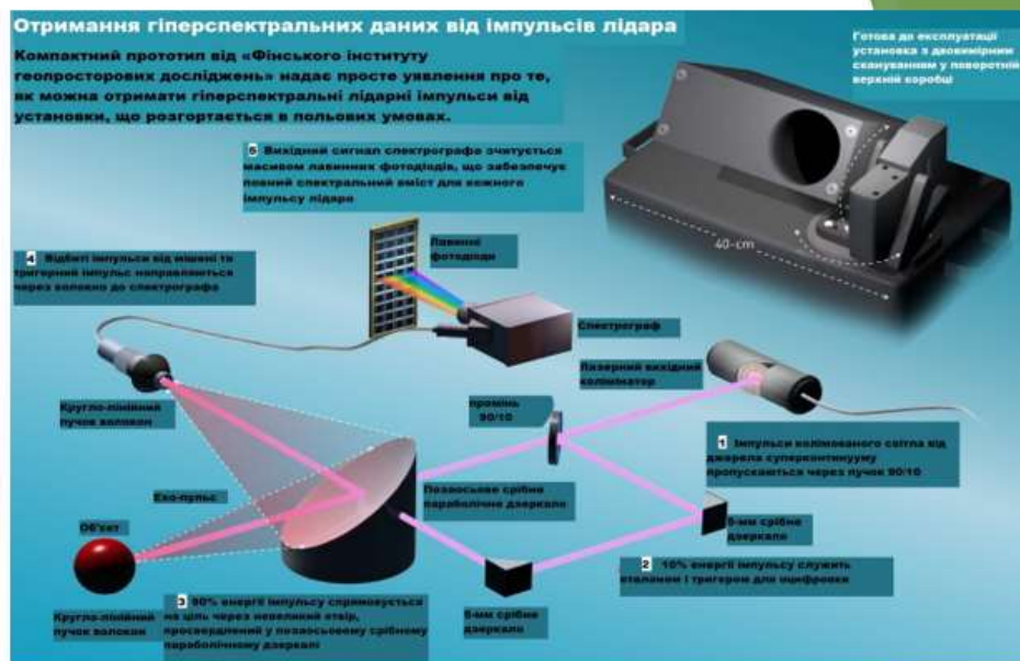
Рисунок 1.3 – Отримання гіперспектральних даних від імпульсів лідара
