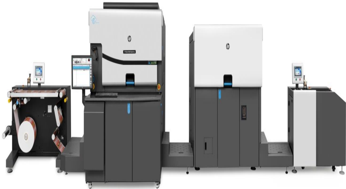
Рисунок 2.5 – Цифрова друкарська машина HP Indigo
