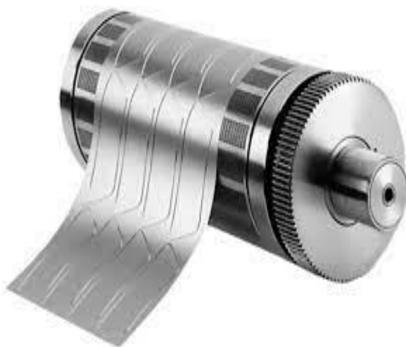
Рисунок 2.6 – Приклад висікальних ножів для вирубки етикетки
