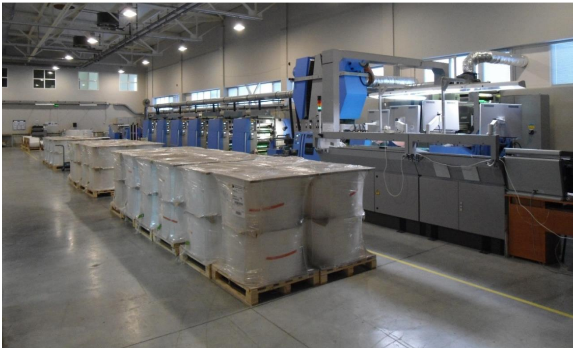
Рисунок 2.4 – Ролева офсетна машина Alprinta 52 V Muller Martinі
