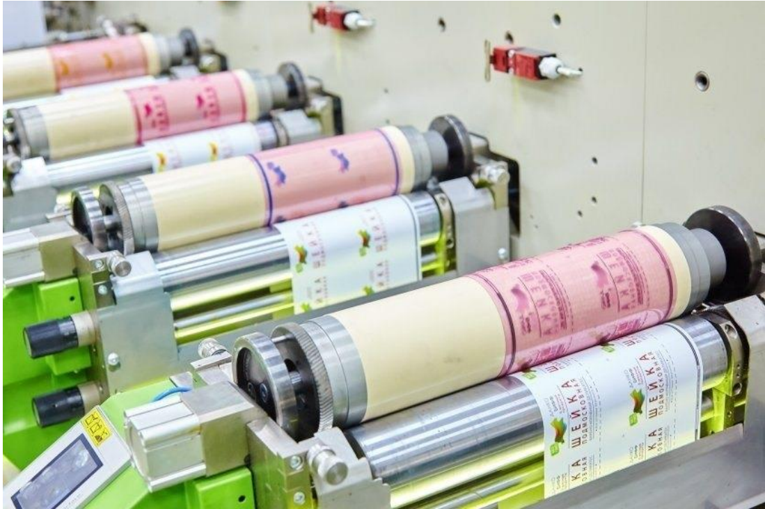
Рисунок 2.2 – Формні циліндри з флексоформами
