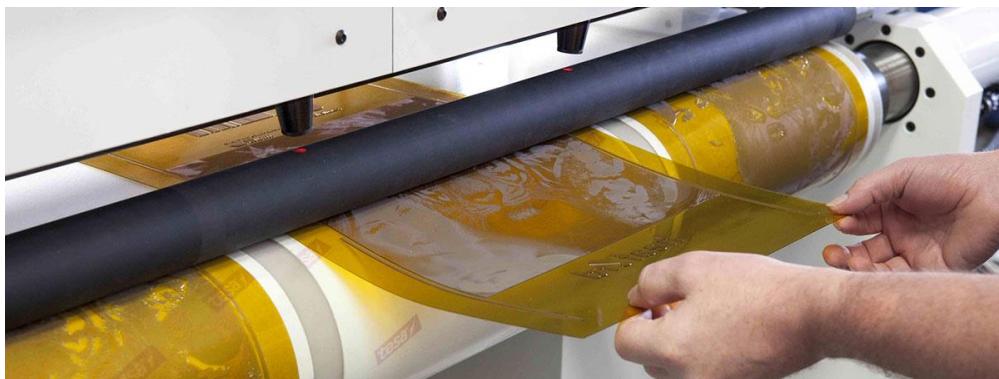
Рисунок 2.1 – Встановлення гнучкої флексоформи
