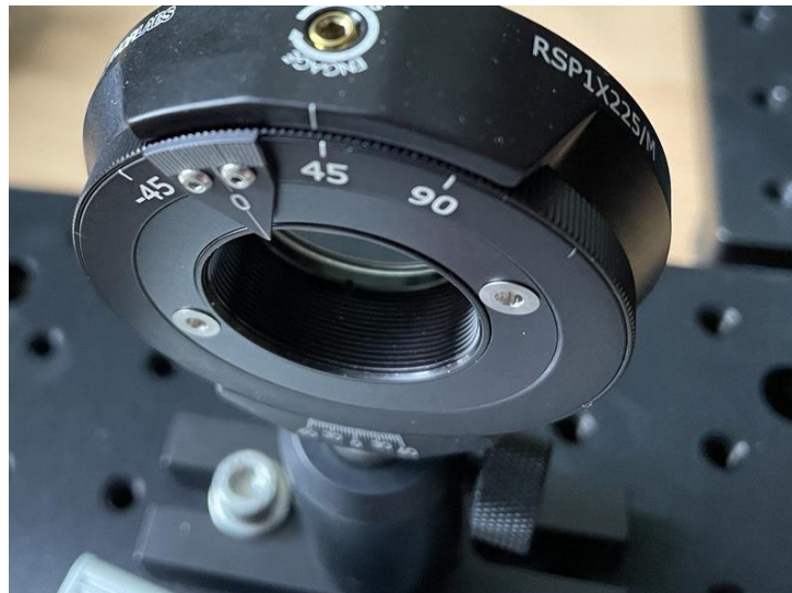
Рисунок 3.5 – Обрання базису та кута поляризації на стороні відправника (Аліси)
