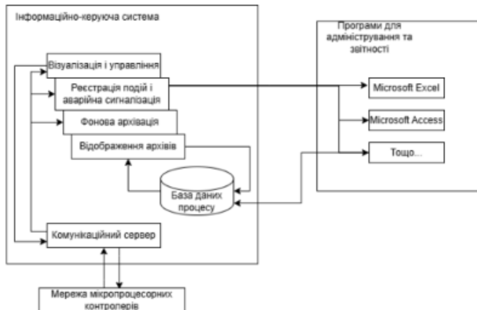
Рисунок 2 – Структуру збору даних і оперативного диспетчерського управління SCADA-системи
