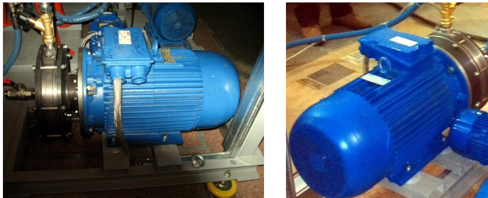
Рисунок 7 – Електричні двигуни 5A160M2U3 18,5 кВт в складі роторних кавітаторів
