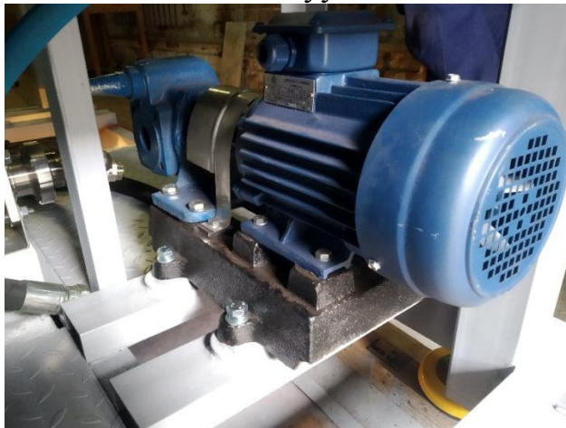
Рисунок 5 – Шестерний насос НМШ 5-25-4,0/4 на рамі з електродвигуном АІР80В4 1,5кВт/1500 об./хв.
