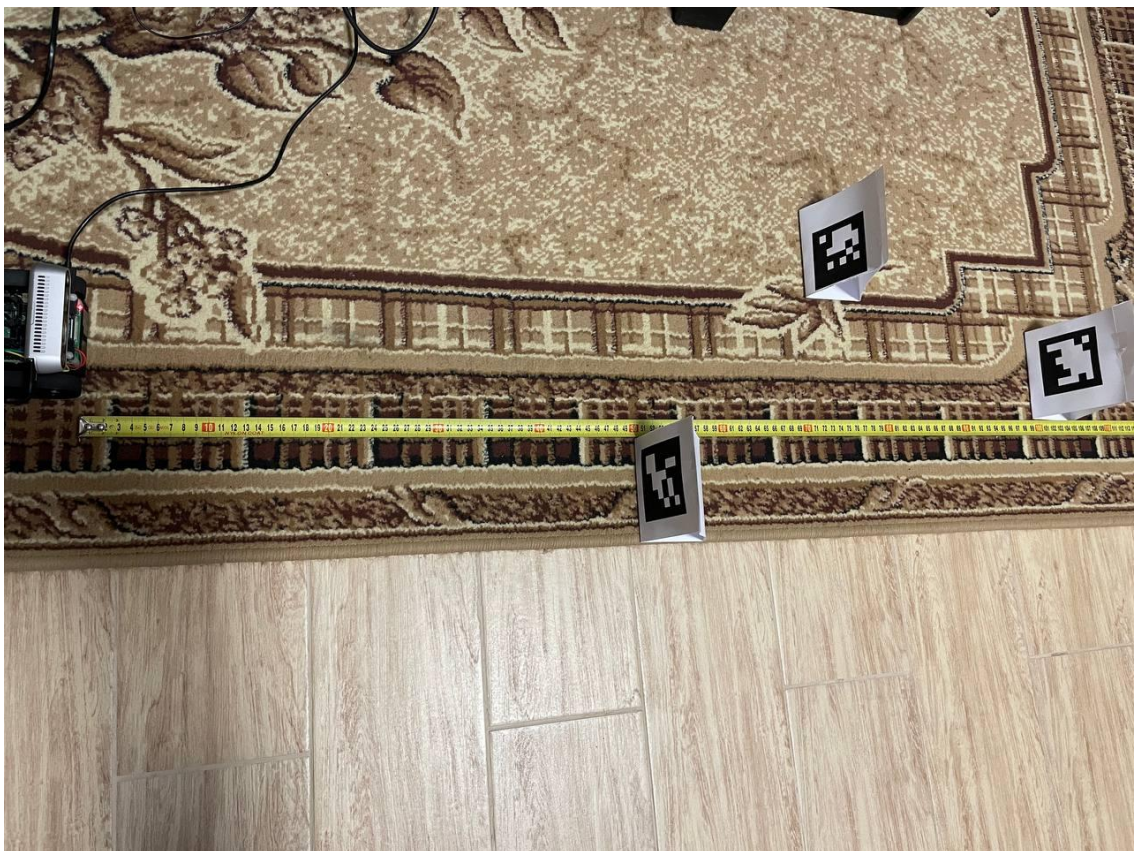
Рисунок 4.7 – Стенд для тестування функції отримання дистанції до маркерів
