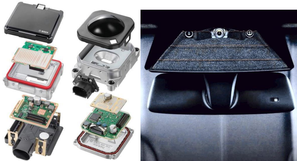
Рисунок 2.8 – Приклади рішень радару та 3D камери
