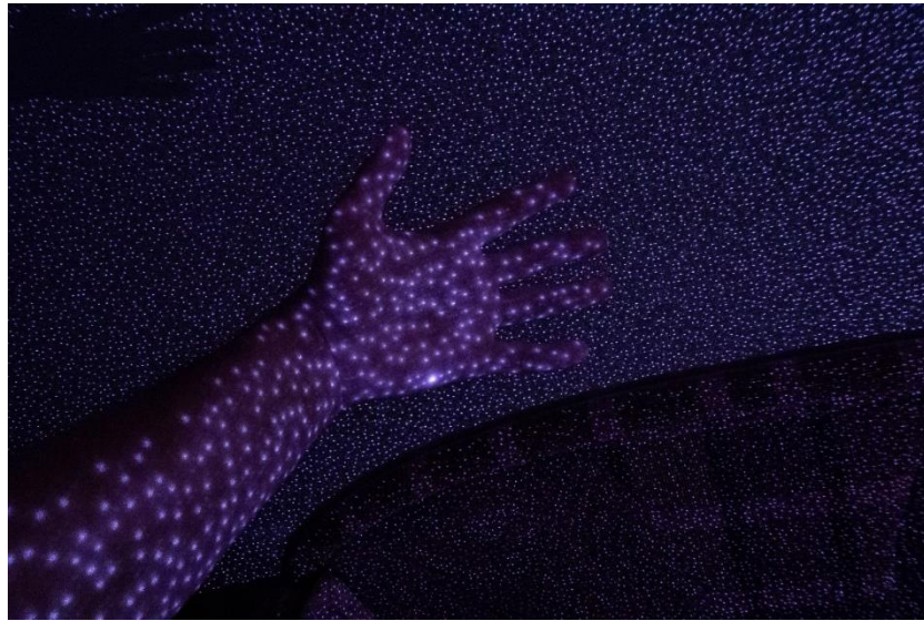
Рисунок 2.16 – Результат отримання паттерну ІЧ камерою
