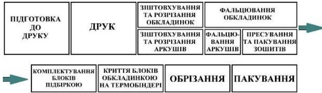
Рисунок 8.1 – Технологічна схема виготовлення видання
