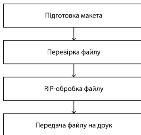
Рисунок 8.4 – Технологічна схема додрукарського процесу цифрового друку
