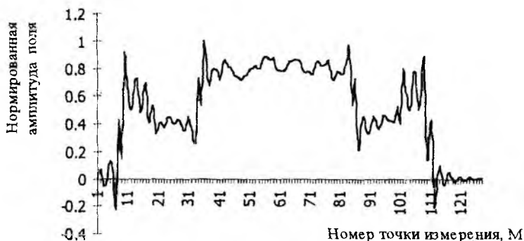
Рис.2 – Измеренное с 10% погрешностью распределение амплитуды поля
