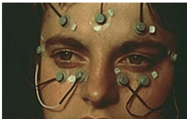
Рисунок 1.1 – Система для реєстрації руху очей
