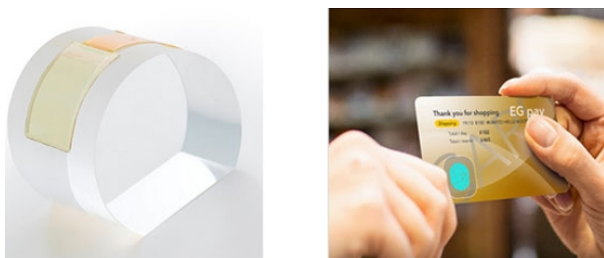
Рис.2. Дактилоскопічний датчик на скляній підкладці з емнісним сенсором
