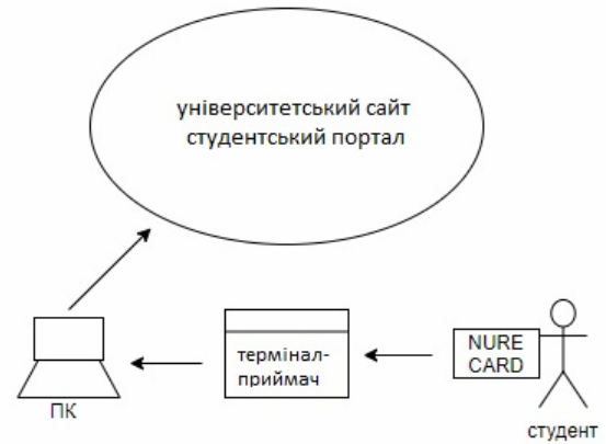
Рис.5. Загальна структурна схема автоматизованої системи контролю
