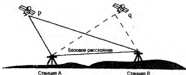
Рис. 2. Формирование двойных разностей наблюдений
