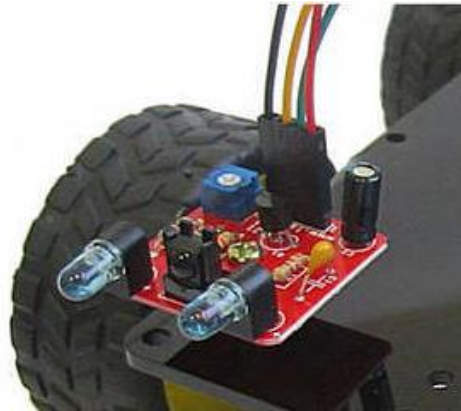
Рисунок 2.1 – Інфрачервоний сенсор перешкод
