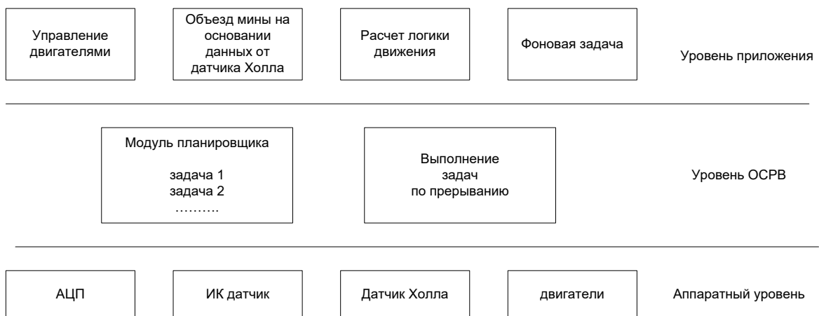
Рисунок 3.1 – Функціональна схема реалізації багатозадачності
