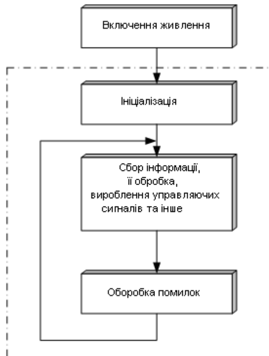
Рисунок 1.4 – Схема алгоритму програми-монітора
