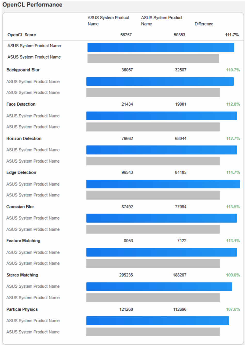
Рисунок 5.43 — Результат отриманий після розгону GTX 1070
