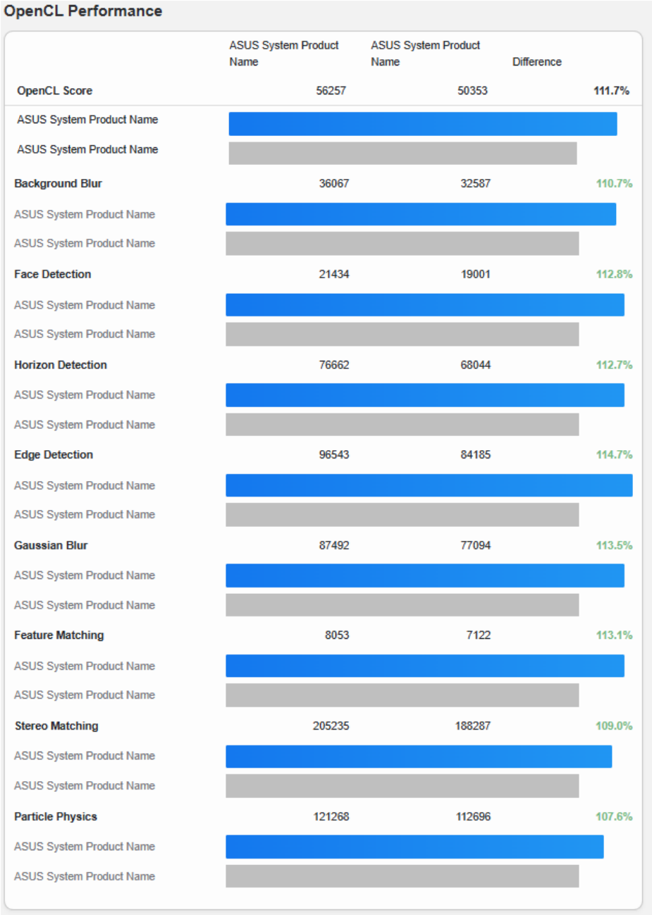
Рисунок 5.26 — Результат отриманий після розгону GTX 1070 8GB
