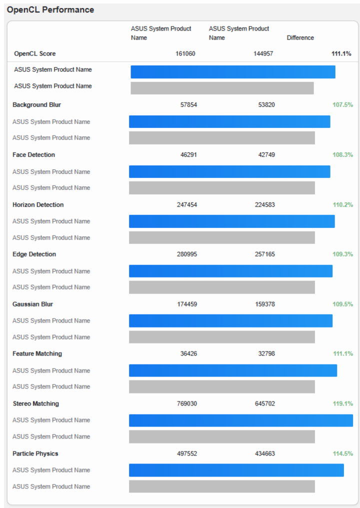
Рисунок 5.21 — Результат отриманий після розгону RTX 3070 TI 8GB
