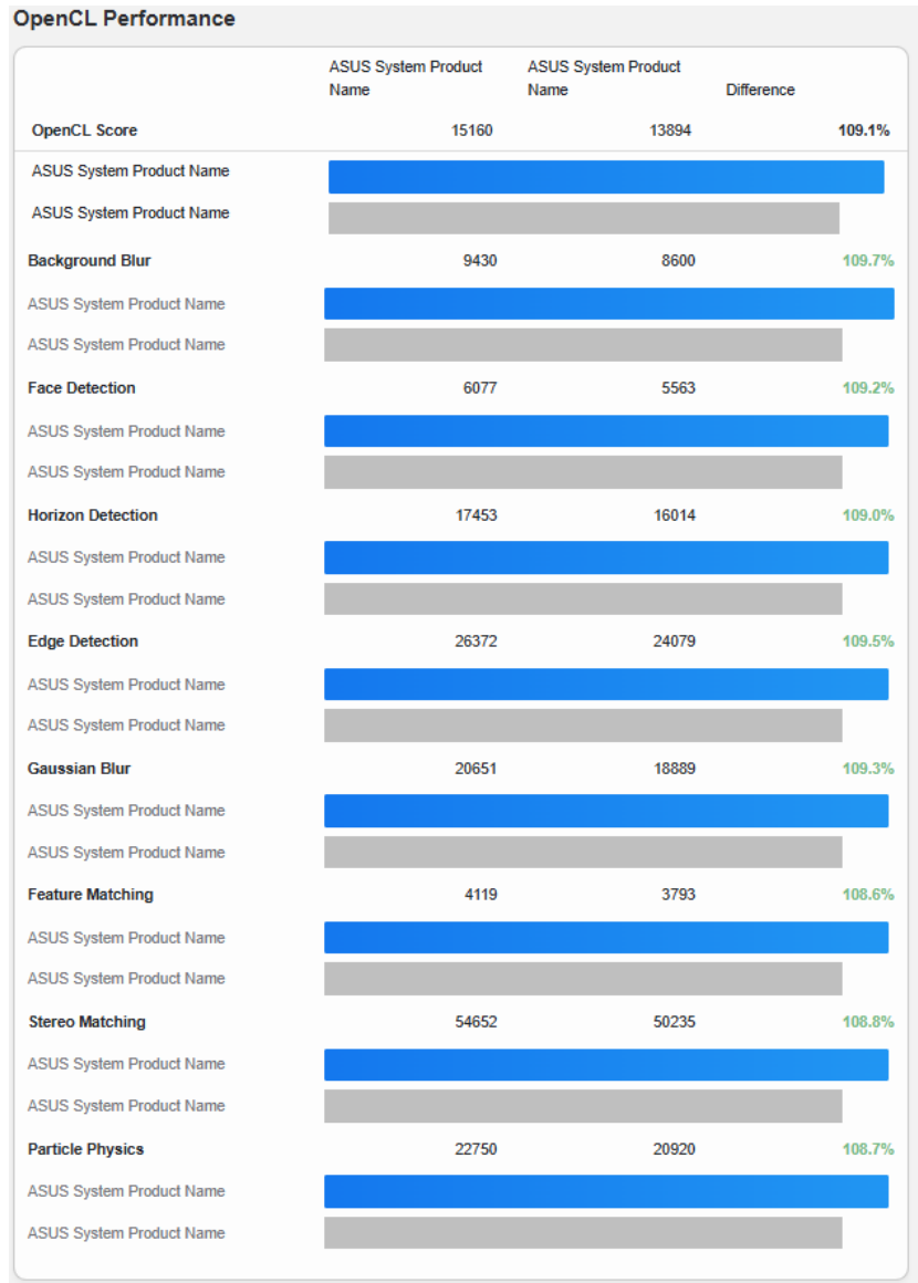
Рисунок 5.32 — Результат отриманий після розгону GTX 570 1.25GB
