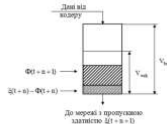
Рисунок 17 – Схематичне зображення процесу заповнення буферного пристрою, спричинене перевищенням бітової швидкості кодової відео поточного рівня пропускної здатності мережі
