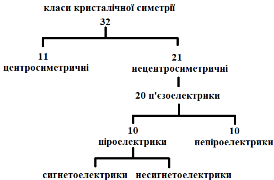
Рисунок 8.1 – Класифікація кристалічних матеріалів, що належать до п'єзоелектрика, піроелектрика та сегнетоелектрика
