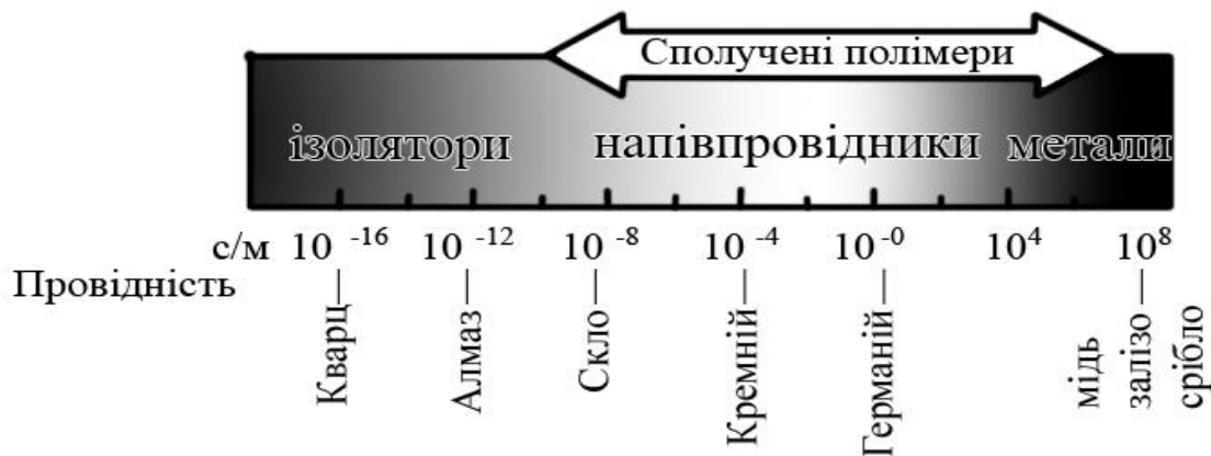
Рисунок 5.1 – Провідність сполучених полімерів порівняно з іншими матеріалами та напівпровідниками
