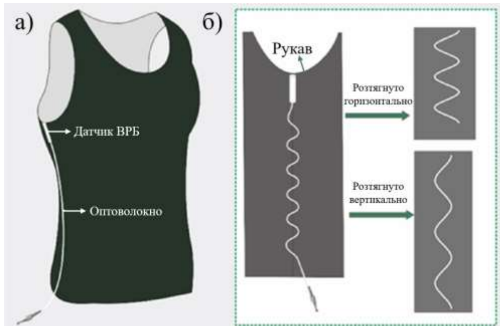
Рисунок 2.8 – Інтеграція ВРБ датчика в одяг. Розташування ВРБ (а), розміщення оптичного волокна (б)
