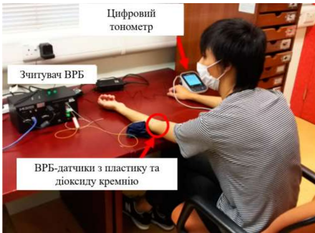
Рисунок 2.6 – Експериментальна установка для вимірювання АТ
