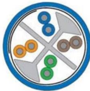
Рисунок 2.3 – E-spline UTP Кат. 6а
