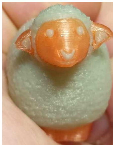
Рисунок 2.24 – Результат друку з використанням мультиматеріальної системи
