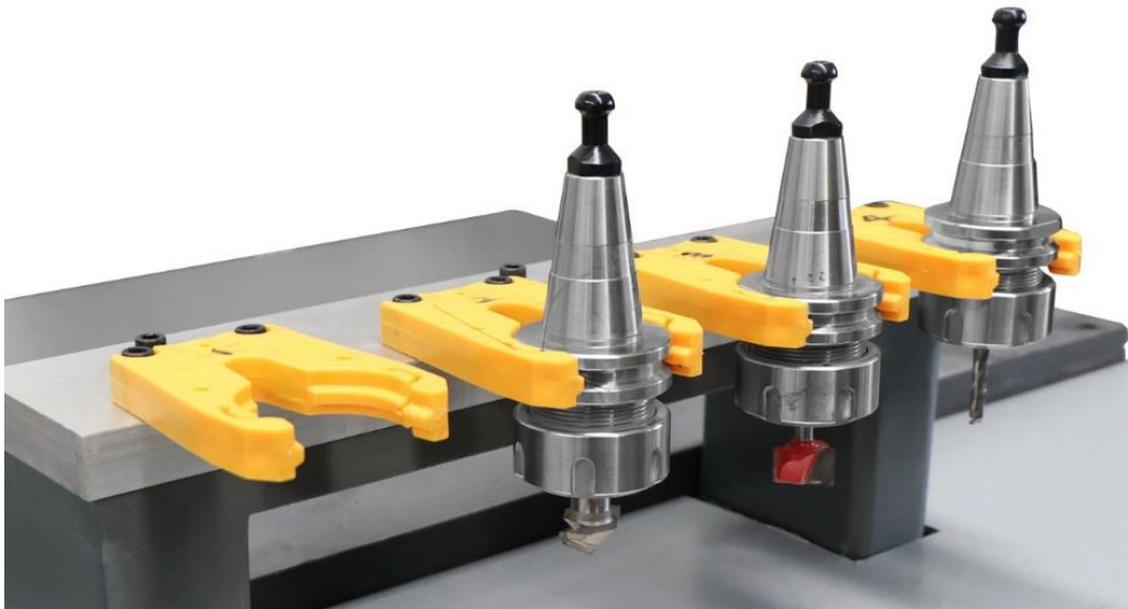
Рисунок 1.10 – Зміна інструменту у фрезерних верстатах з ЧПК
