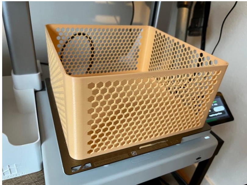
Рисунок 1.4 – Корзінка надрукована на 3D принтері за технологією FDM
