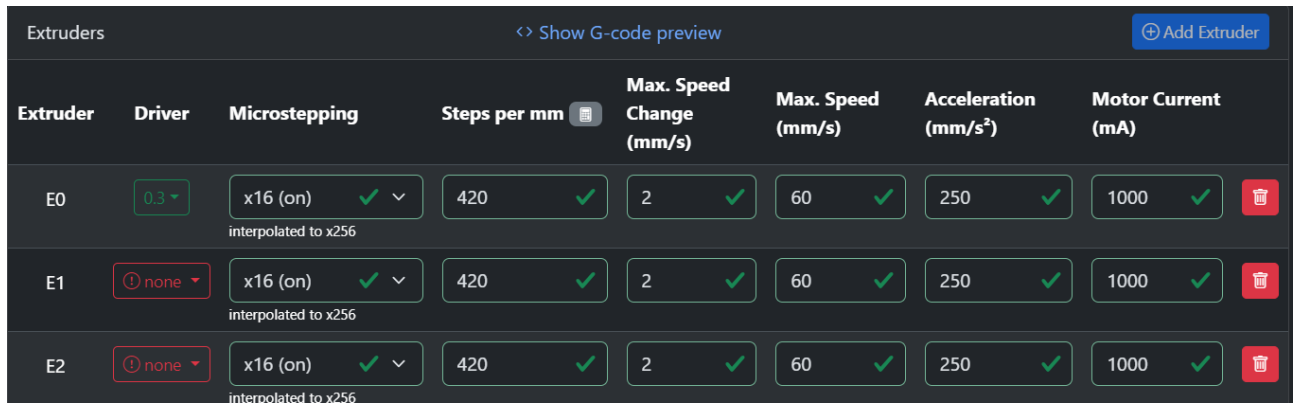
Рисунок 2.14 – Налаштування екструдерів в RepRap Firmware
