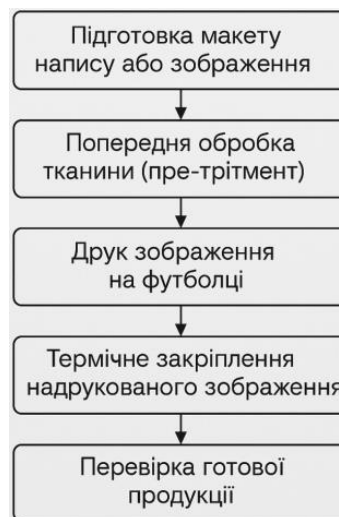
Рисунок 6.2 – Загальна технологічна схема виготовлення футболки
