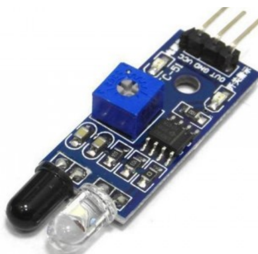
Рисунок 3.2 – Інфрачервоний датчики руху типу IR-перешкод
