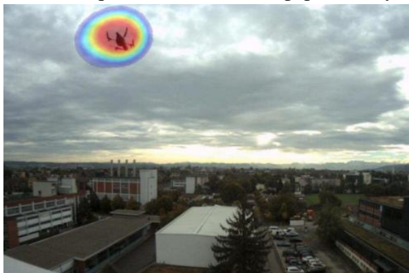
Рис. 8. Образ акустичних сигналів, накладений на оптичне зображення квадрокоптера Parrot AR Drone 2.0 [23]
