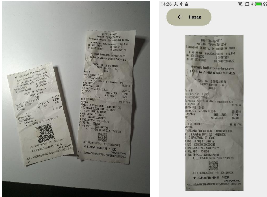
Рисунок 3.14 – Робота програми при наявності двох чеків на фото: а) вихідне фото з двома чеками; б) результат роботи програми з одним вирівняним чеком
