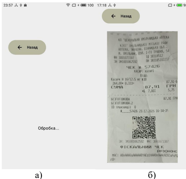
Рисунок 3.12 – Відображення роботи другої сторінки застосунку: а) повідомлення про обробку зображення; б) відображення результату роботи у вигляді перспективно вирівняного чека
