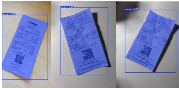
Рисунок 2.11 – Приклад роботи сегментації для виявлення чеків
