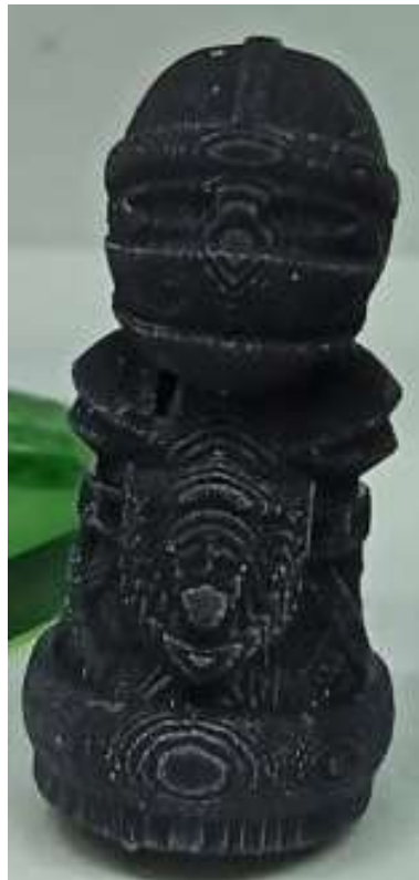
Рисунок 1.10 – Результат друку на принтері Photon Zero
