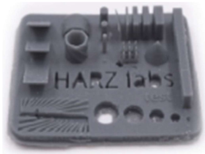
Рисунок 4.5 – Модель надрукована з малим часом експонування
