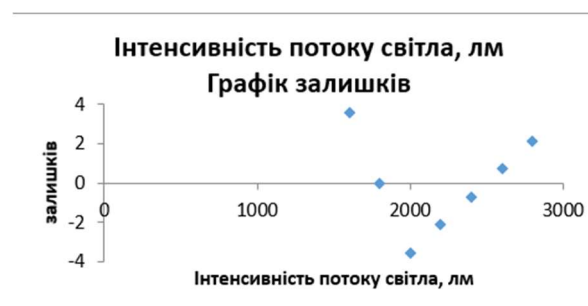
Рисунок 5.10 – Графік залишків інтенсивності потоку світла на робочу поверхню
