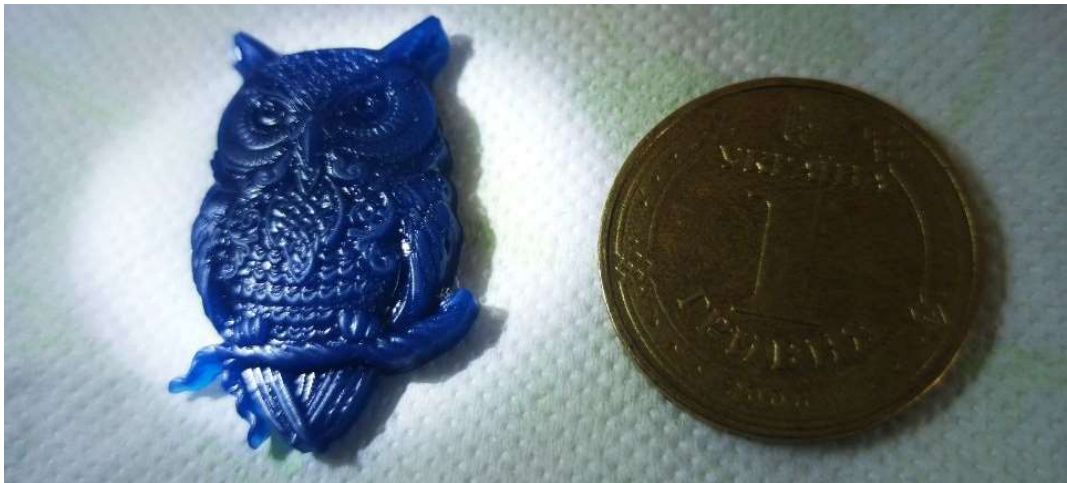
Рисунок 4.18 – Модель надрукована фотополімером PlexiWire з розміром шару в 20 мкм
