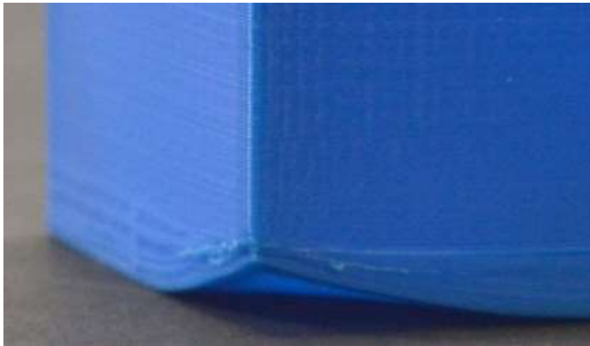
Рисунок 4.8 – Зміна геометрії моделі при використанні недостатньої кількості базових шарів з малим часом експонування
