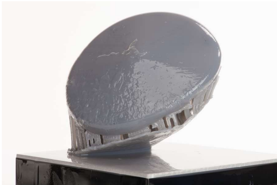
Рисунок 4.1 – Дефект друку, при якому модель має деламіновану поверхню
