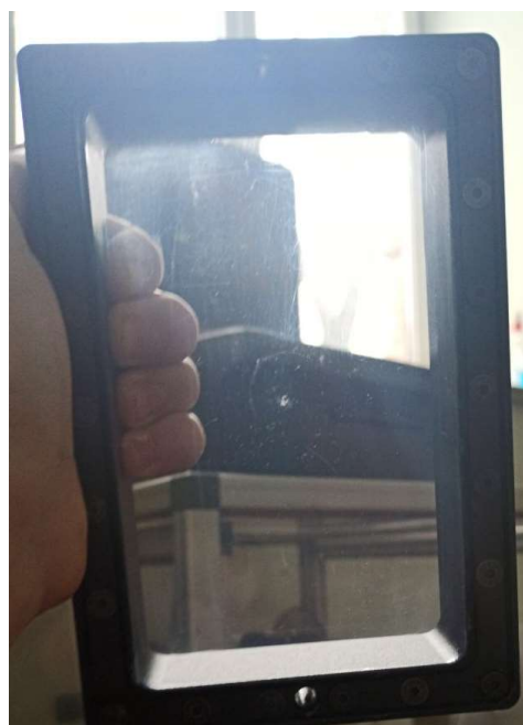
Рисунок 4.20 – FEP-плівка з видимими дефектами поверхні
