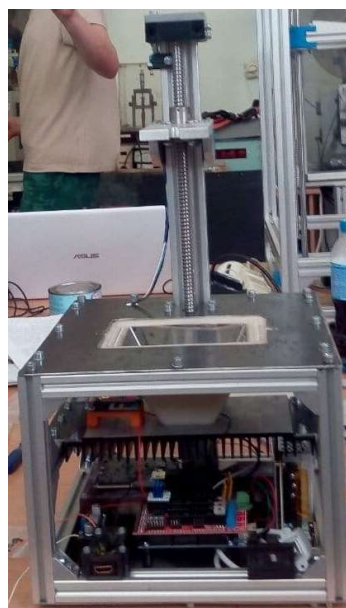
Рисунок 3.19 – Зображення фотополімерного принтера зі встановленою електронікою
