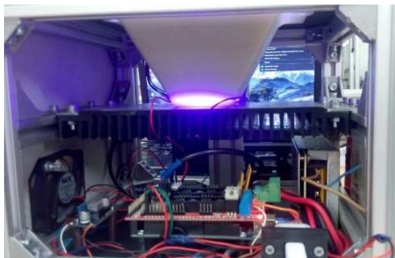
Рисунок 2.7 – Компоненти встановлені в корпусі першого варіанта принтера
