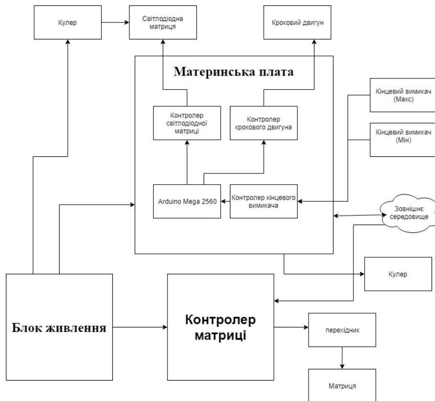
Рисунок 2.6 – Блок-схема макету фотополімерного 3D-принтера
