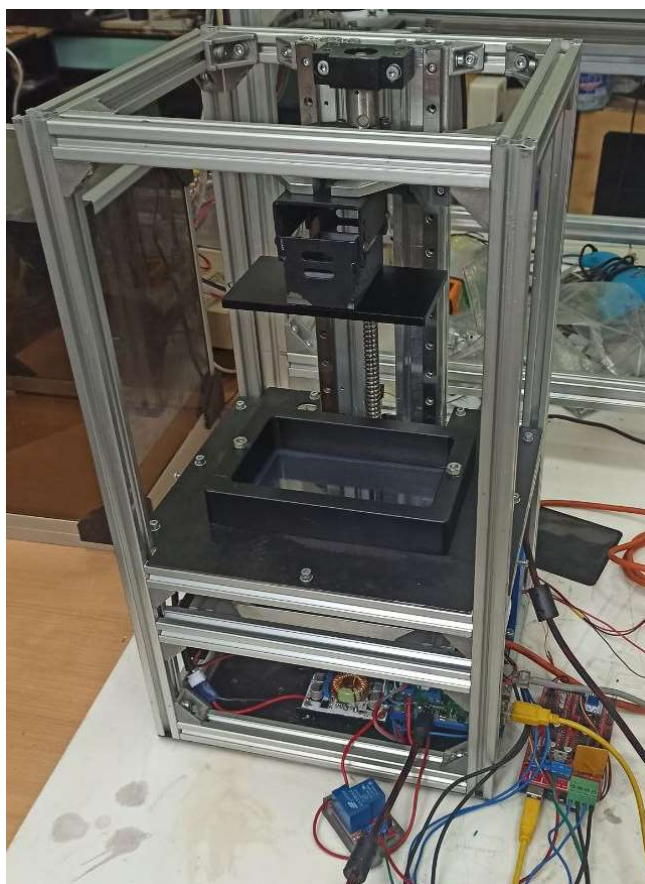
Рисунок 3.29 – Оновлений принтер, що використовує Raspberry Pi 4 та RAMPS 1.4 з Arduino Mega 2560
