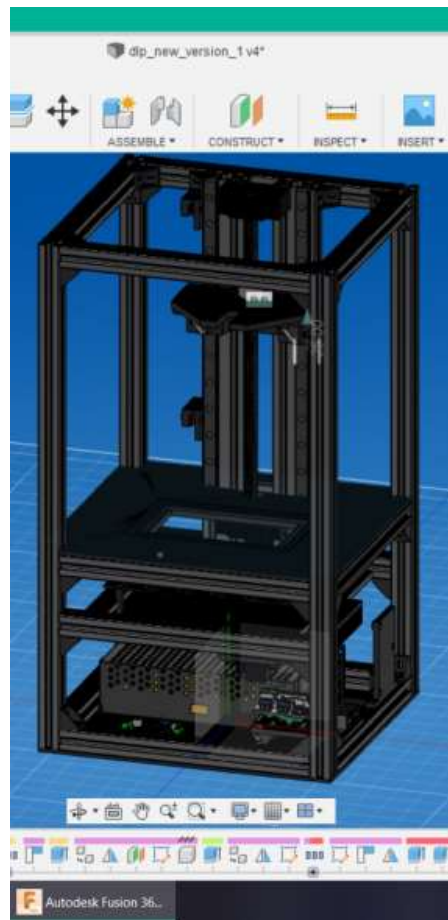
Рисунок 3.11 – Модель принтера зі встановленою матрицею та кріпленням для екрану
