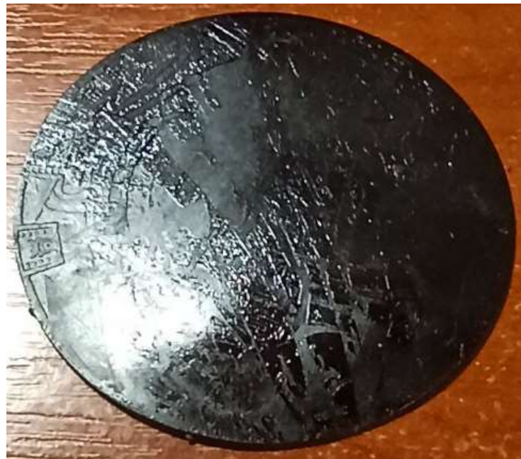
Рисунок 4.9 – Модель надрукована з меншою висотою переміщення
