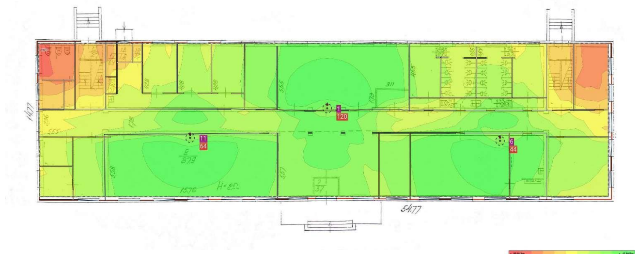
Рисунок 4.7 - Результат радіопланування першого поверху
