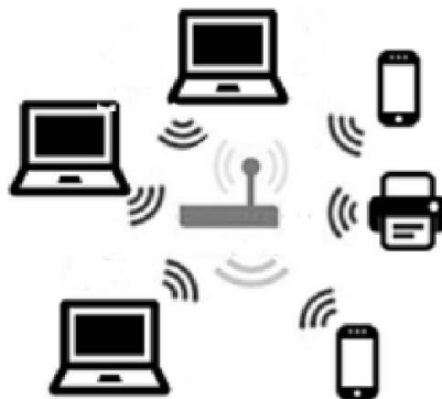
Рисунок 1.5 – Схема роботи мережі в BSS
