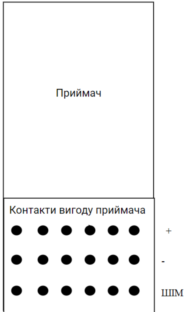
Рисунок 2.6 – Схема підключення приймача радіосигналу
