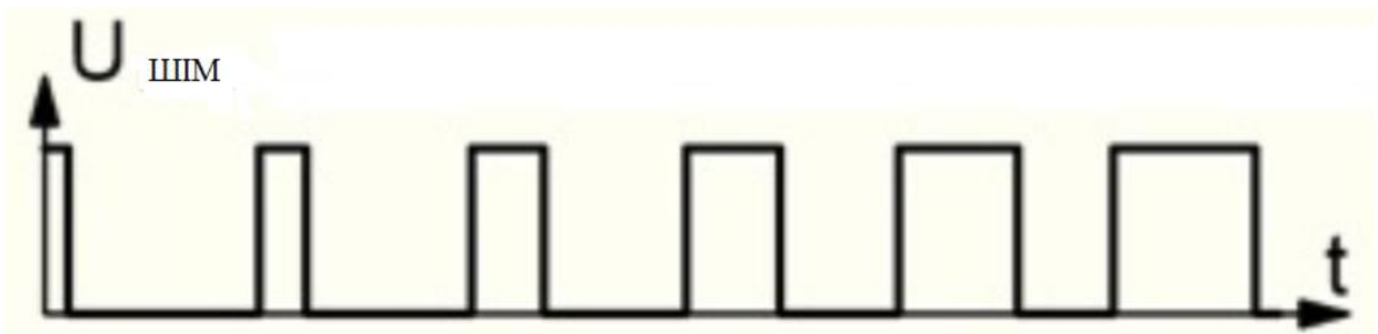
Рисунок 2.4 – Приклад ШІМ сигналу
