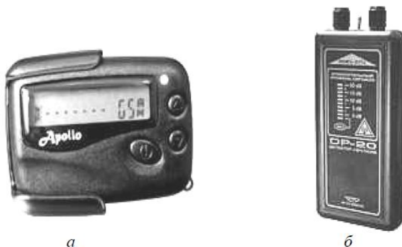
Рисунок 1.24 - Индикаторы поля: а – частотомер «Оберег», б – «DP-20»
