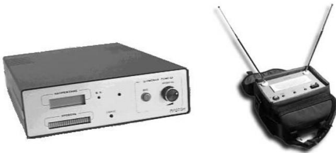
Рисунок 1.61 - Устройство комплексной защиты телефонной линии «ПРОТОН» и устройство активной защиты информации BFG-01
