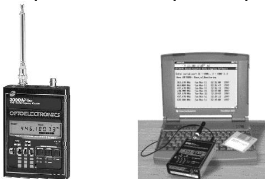
Рисунок 1.27 - Портативный многофункциональный частотомер «3000A Plus»
