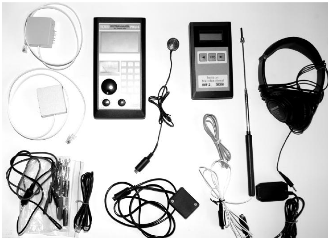
Рисунок 1.29 - Портативный комплект для обнаружения средств съема информации и выявления каналов ее утечки «ПКУ-6М»
