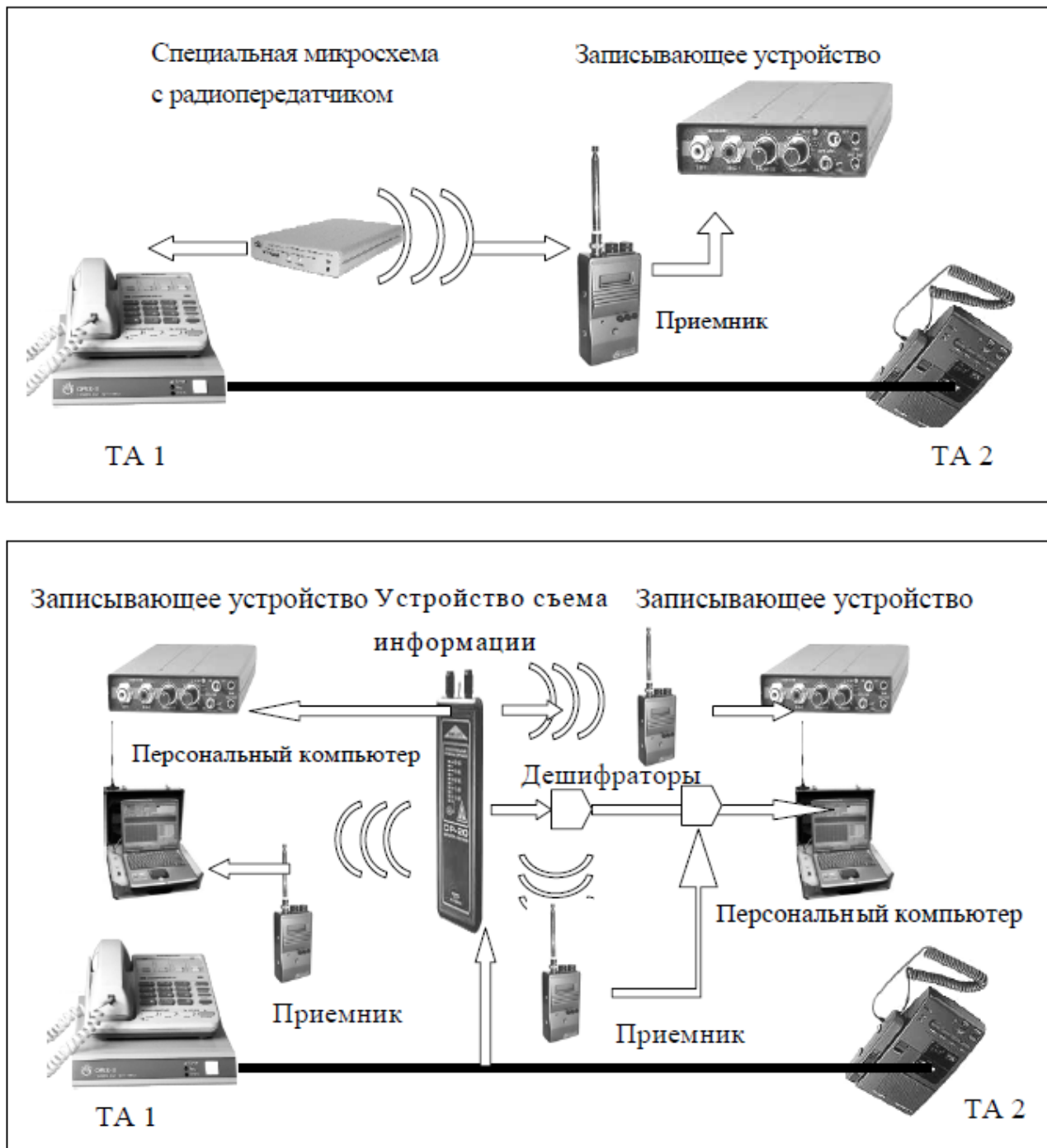
Рисунок 1.5 - Схемы возможных вариантов подключения к телефонной линии с использованием радиоканала
