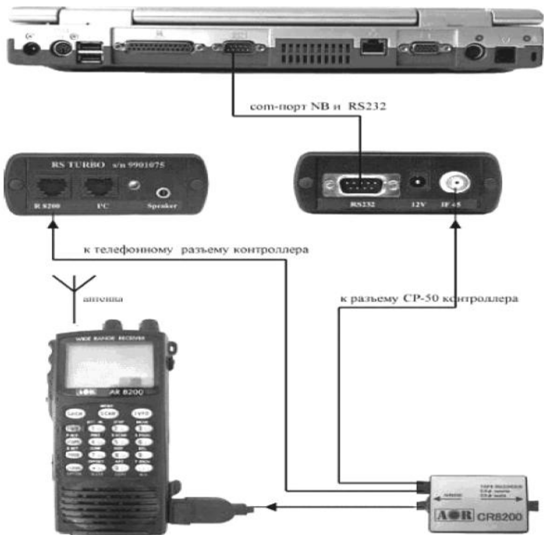
Рисунок 1.38 - Комплекс RS turbo: a – общий вид, б – схема включения
