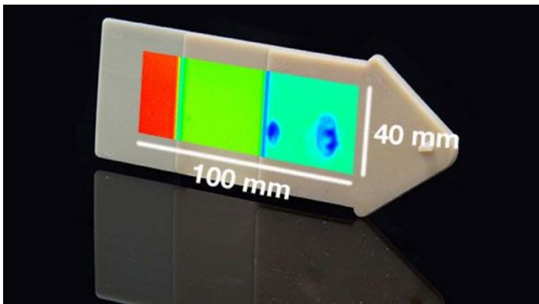
Рисунок 3.1 – Терагерцеве зображення виявляє приховані бульбашки повітря в полімерних матеріалах.
