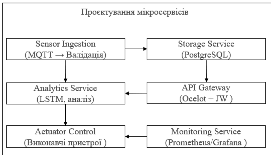
Рисунок 3.3 – Структурна діаграма проєктування мікросервісної системи адаптивного керування мікрокліматом
