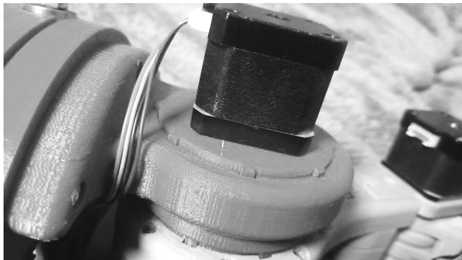
Рисунок 3.5 – Зовнішній вигляд планетарного редуктора з передавальним числом 1:64
