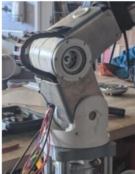
Рисунок 3.7 – Конструкція суглоба маніпулятора з вбудованим редуктором
