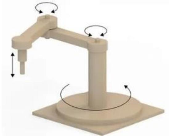
Рисунок 1.8 – Кінематика SCARA маніпулятора
