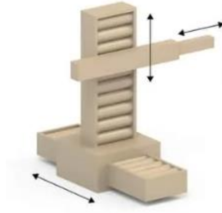
Рисунок 1.5 – Кінематика ортогонального робота маніпулятора
