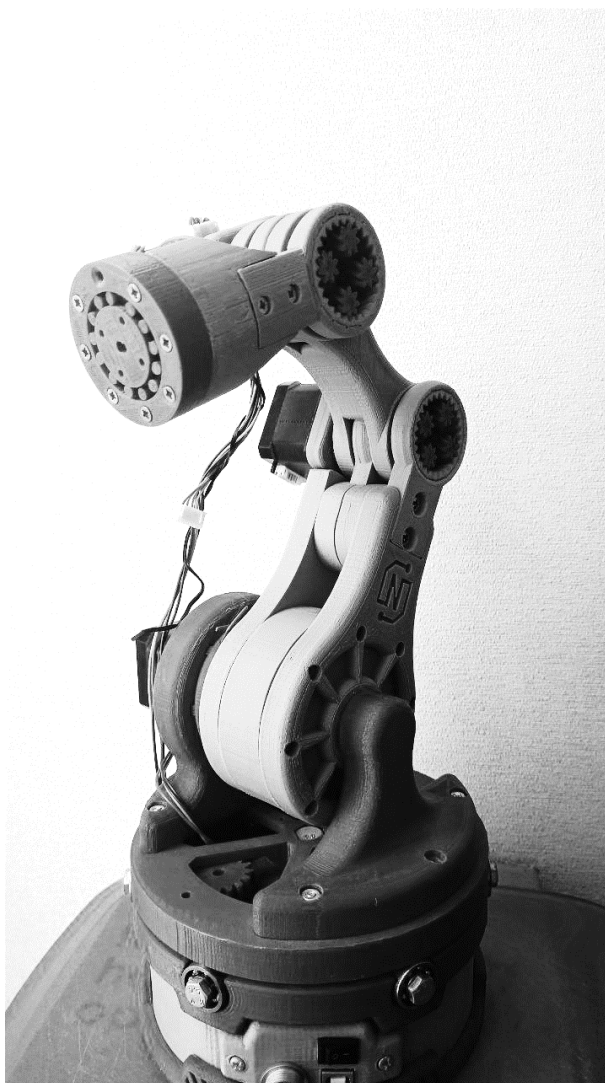
Рисунок 3.1 – Зовнішній вигляд макету багатоланкового промислового маніпулятора
