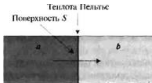
Рисунок 1.12 – Перенесення тепла за допомогою електричного струму
