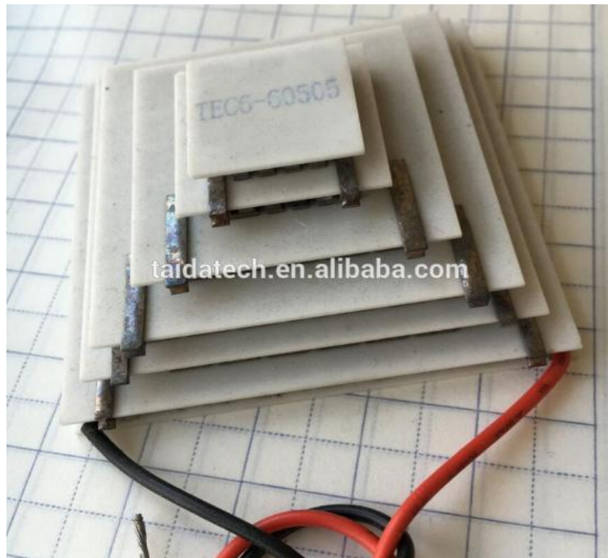
Рисунок 2.10 – Шестишаровий модуль елементів Пельтьє
