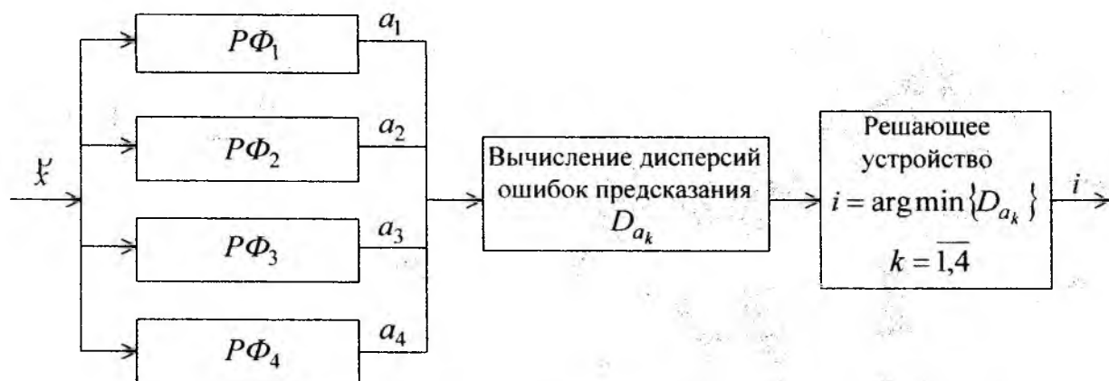
Рис. 1. Структура устройства распознавания метеообъектов по минимуму ошибки предсказания решетчатого фильтра
