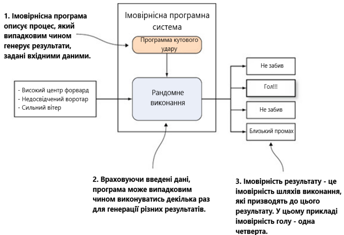
Рисунок 2.9 – Імовірнісна програма визначає процес випадкової генерації вихідних даних по відомим вхідним
