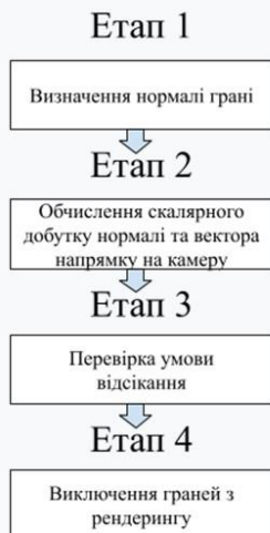
Рисунок 4 – Етапи реалізації методу Backface Culling
