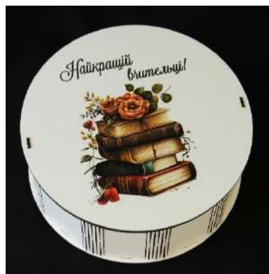
Рисунок 4 – Пакування з дерево-волокнистих матеріалів, виготовлене лазерним розрізуванням: а – фанера; б – ХДФ
